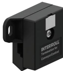
Le petit boîtier de terminaison sert de résistance terminale pour la ligne de communication du système ConveyorControl. Le boîtier de terminaison est directement vampirisé sur le câble plat.
